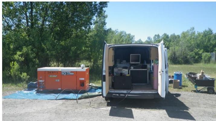
“ Analyses effectuées sur site, à l'aide d'un camion laboratoire équipé d'analyseurs  $\mu\text{GC/MS}$  et  $\text{TDGC/MS}$  (thermo-désorption). ”
