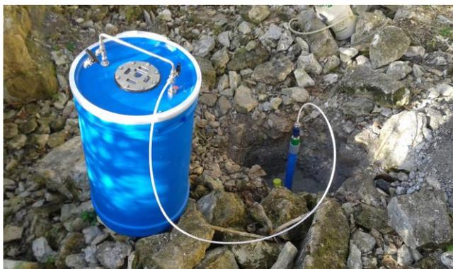
“ Prélèvements réalisés par Explorair ou par le client, sur une poche (sac Tédlar), en quelques minutes, puis analyse au laboratoire. ”
